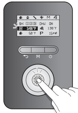
3. Faites tourner le cadran de commande (🌀) vers la droite ou la gauche pour augmenter ou réduire la température.
