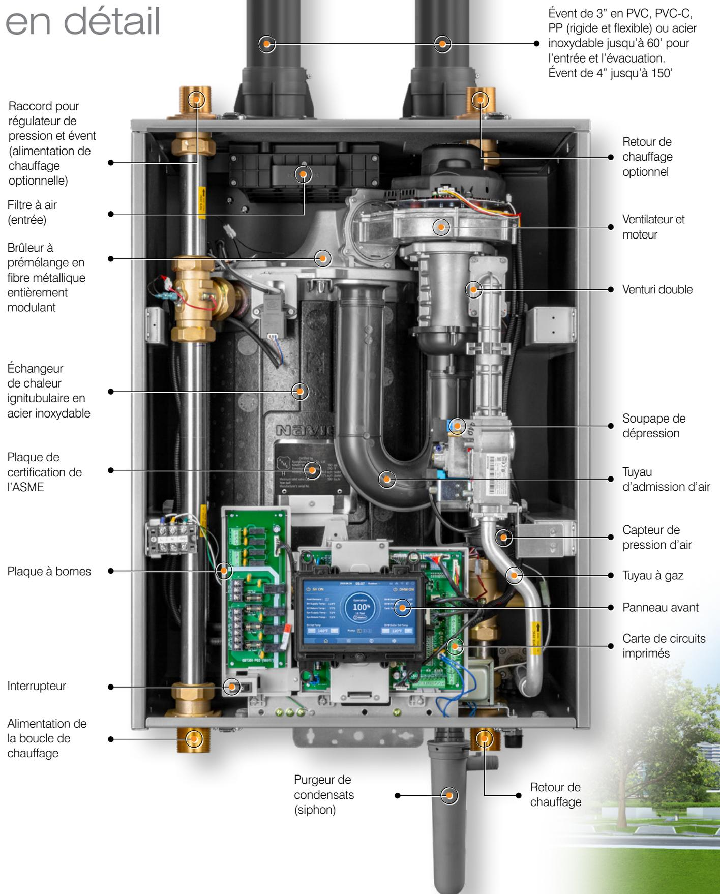
Évent de 3" en PVC, PVC-C, PP (rigide et flexible) ou acier inoxydable jusqu'à 60' pour l'entrée et l'évacuation. Évent de 4" jusqu'à 150'
