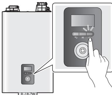
Lorsque la chaudière est allumée, elle passe automatiquement en mode d'opération normal et les conditions de fonctionnement de la chaudière s'affichent à l'écran.
