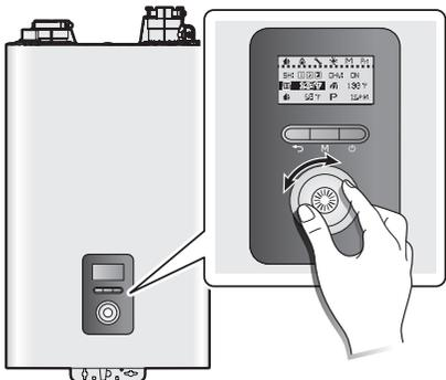
2. Appuyez sur le cadran de commande (🌀) pour sélectionner la température de chauffage des locaux. La section mise en évidence clignote.
