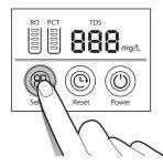
13. Appuyez de nouveau sur le bouton de réinitialisation pendant 3 secondes jusqu'à ce que vous entendiez le système émettre un bip. Le filtre est maintenant correctement réinitialisé.
