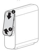
5. Faites tourner le filtre à 90 degrés dans le sens inverse des aiguilles d'une montre pour le détacher de l'appareil (il se détache lorsque l'îcône « ▷ » du filtre fait face à l'îcône « □ » de l'appareil).
