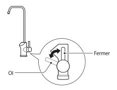
4. Retirez le panneau avant de l'appareil de filtration par Ol.
